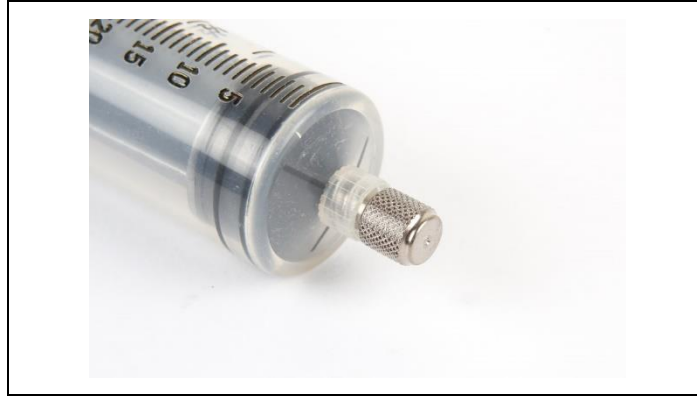
شکل (۴-۱۰): درپوش قفلی فلزی بر روی خروجی سرنگ
