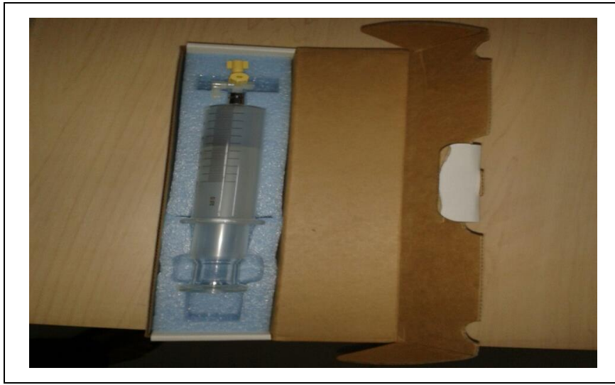
شکل (۴-۱۲): ظرف نگه‌دارنده سرنگ نمونه روغن
