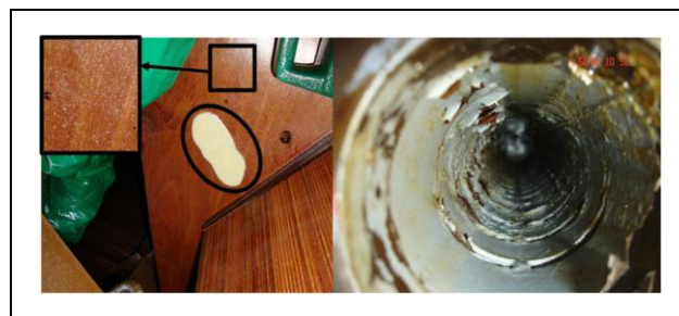
شکل (پ ۵-۳): تصاویر درون ترانسفورماتور و نقاطی که رنگ درون لوله رادیاتور جدا شده است.
